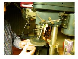
il ciocco viene lucidato per evidenziare la fiammatura, che deve sempre essere in armonia con la forma della pipa. La pipa viene disegnata direttamente sul ciocco, vengono disegnate le linee del fornello, fori collegamento con il bocchino, tutte le dimensioni vengono verificate con autocad 3D.
