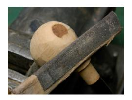
Il resto della lavorazione viene eseguita totalmente a mano, con utilizzo di lime costruite con tele smeriglio, seguono numerosi passaggi di tele sempre più sottili, viene eseguita la colorazione con tampone e coloranti naturali.
