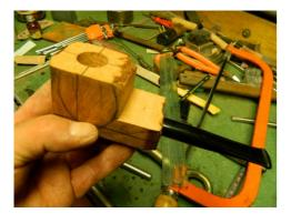
con il trapano a colonna viene realizzato il foro iniziale "fornello" diam. 17 o diam. 20, viene eseguito il foro collegamento bocchino/fornello, che può essere da 3 mm. oppure da 4 mm. Viene eseguito il foro perno bocchino che può essere diam. 8 oppure diam. 9, Il bocchino può essere in EBANITE oppure in METACRILATO
