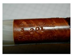
L'ultima operazione è la marchiatura, la qualità della pipa: ( 3 pipa perfetta, 2 con minimi difetti, 1 stuccature evidenti )
